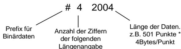
Um die Tracedaten direkt in ein Float-Array lesen zu können muß eine spezielle Funktionsdeklaration erstellt werden.
